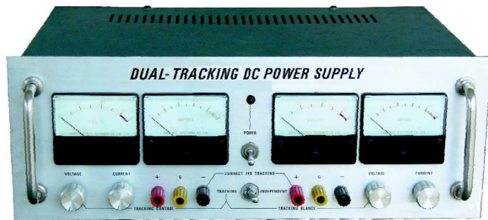
圖 1-1-7 雙電源型電源供應器之常見面板
